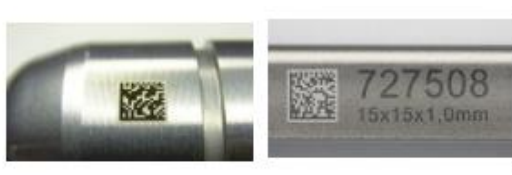
Figura 13. Exemplos de marcação a laser em peças metálicas.
