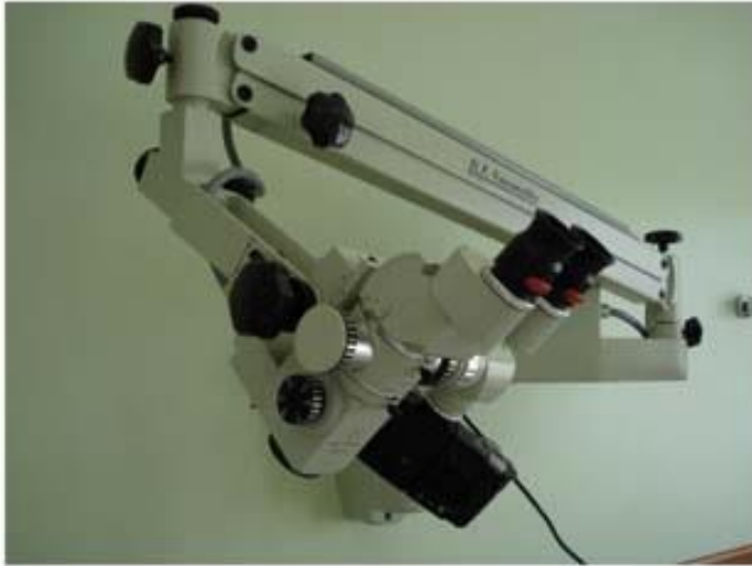
Figura 1: Microscópio operatório com câmera digital acoplada ao divisor de luz.
